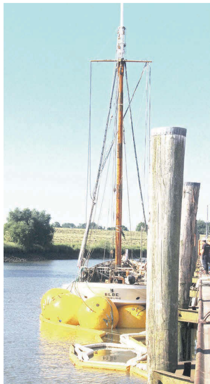
Der Lotsenschoner wurde mit Hilfe von Hebesäcken geborgen und steht nun wieder aufrecht in der Schwingemündung Foto: It
